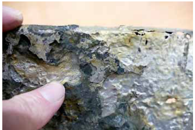
Foto 2.2 zeigt eine Detailaufnahme von Bild 2.1 mit gut erkennbarem Materialabtrag.
