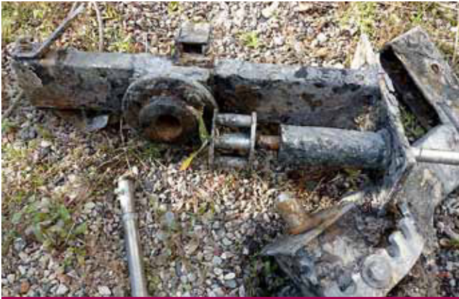
Foto 1.1: ätzartige Korrosion an einem Tauchmotorrührwerk.
