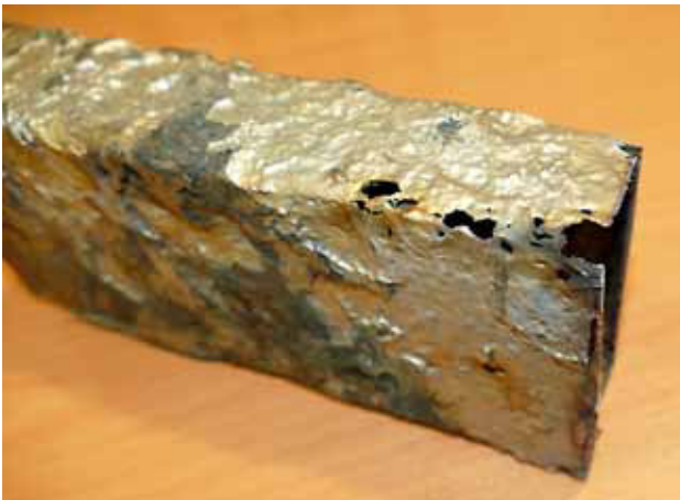
Foto 2.1 zeigt einen korrodierten Träger eines Tauchmotorrührwerks.
